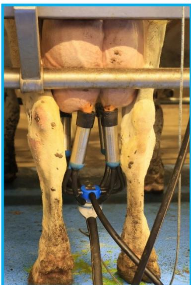
Процесс доения должен быть щадящим, но при этом вымя должно быть достаточно выдоено. Это включает в себя обеспечение того, чтобы аппарат висел прямо и равномерно нагружал четверти вымени. Молочный шланг не должен оказывать стягивающего воздействия на доильный аппарат.
