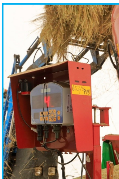
Большие, легко читаемые и поворотные дисплеи важны для того, чтобы водитель колесного погрузчика мог считывать данные о количестве загрузки со своей машины. Фото: KFM
