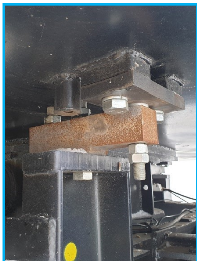
Каждый кормосмеситель должен иметь весы. Такие гибочные стержни являются основой технологии взвешивания. Фото: KFM
