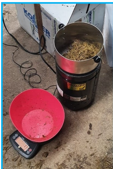
Сушильный шкаф используется для определения содержания сухого вещества и, следовательно, количества воды, которую необходимо добавить. Фото: KFM
