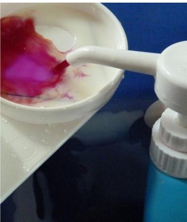
Schalmtest Zugabe der Testflüssigkeit.
