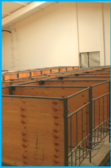
Geschlossene Boxenwände verhindern das Belecken der Kälber. Sehr gut gemacht sind die drei Halterungen für Müsli- und Wassereimer. Es fehlt (noch) eine Halterung für Nuckeleimer.
