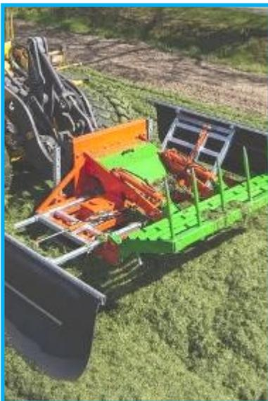
Mit Siloverteilern lassen sich die gewünschten dünnen Schichtstärken für eine gute Verdichtung erreichen.
