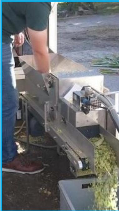
TM-Messung mit mobilem NIRS-Gerät durch einen Dienstleister.
