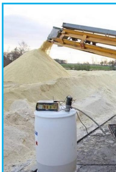
In den vielen Fällen bietet sich eine Konservierung mit Propionsäure an. Die Funktion der Dosiereinrichtung ist ständig zu überwachen.
