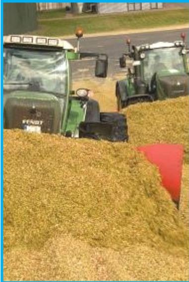
Wird das Futter vor den Silos abgeladen, sind leistungsfähige Schlepper oder Radlader zum Hochschieben erforderlich.
