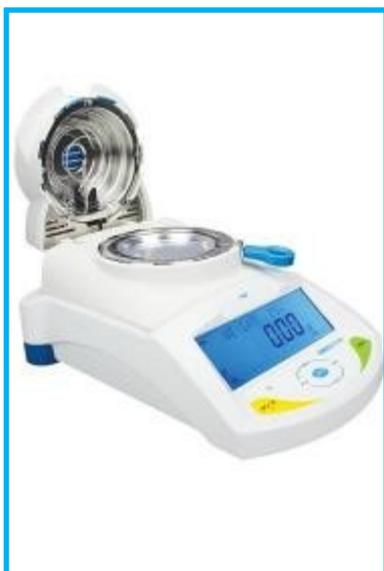
Viele Geräte zur TM-Bestimmung können nur kleinste Probenmengen messen. Dadurch nimmt die statistische Sicherheit des Ergebnisses stark ab.
