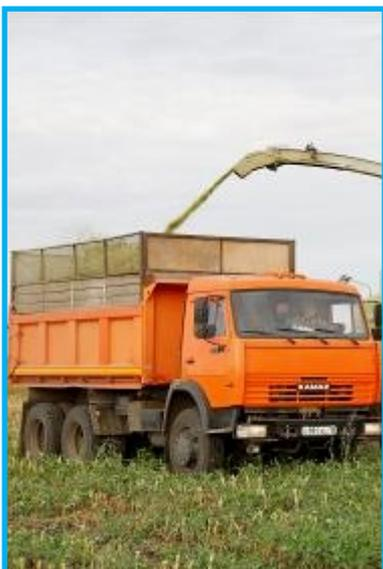
*Bei großen Entfernungen und auf trockenen Flächen sind LKW gut geeignet, bei feuchten Verhältnissen hinterlassen sie oft unerwünschte Bodenverdichtungen.*
