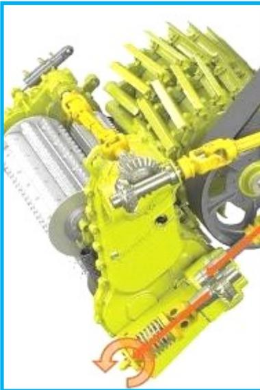
Bei allen Häckslermarken ist die genaue Einstellung der Häckselaggregate für die Futterqualität wichtig.
