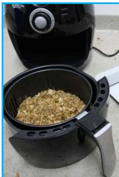
Selbst einfache Trockenfritteusen sind zusammen mit einer genauen Waage zum Bestimmung der TM geeignet.
