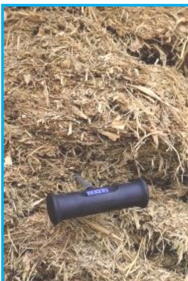
Die Temperaturverhältnisse an der Anschnittfläche lassen Rückschlüsse auf etwaige Silierfehler zu.
