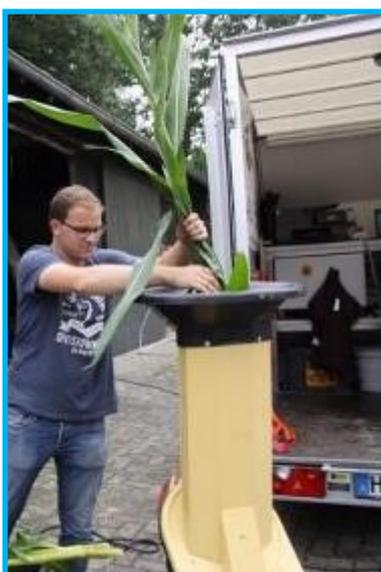
Egal für welche Messtechnik: die Pflanze muss zuvor zerkleinert werden. Gut geeignet sind handelsübliche Gärtenhacksler.
