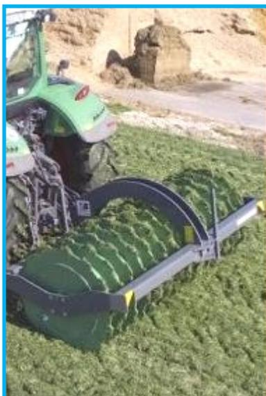
Solche Anbauwalzen lassen sich mit Wasser füllen, sie unterstützen die Walzwirkung des Schleppers erheblich.
