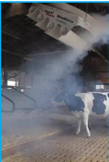
*Einen geführten und beschleunigten Luftstrom produziert der Windforce5 von CowHouse.*
