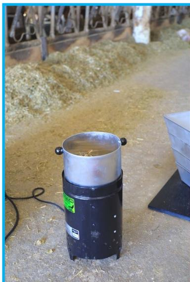
Die tatsächliche Trockenmasse weicht oft erheblich von der errechneten ab. Trocknungsöfen liefern schnell Prüfergebnisse.
