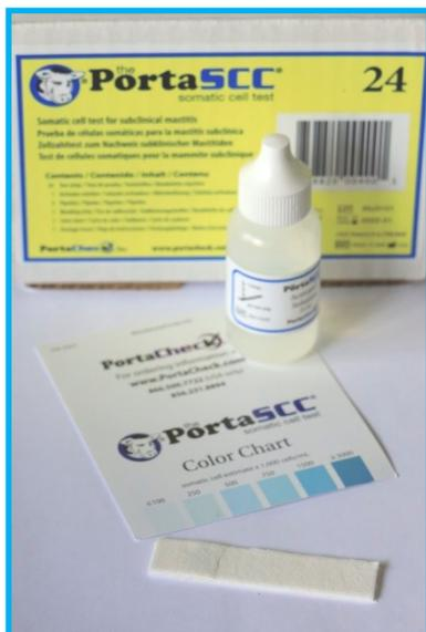
Mit diesem einfachen Teststreifen lassen sich verdächtige „Zellmillionäre“ schnell identifizieren. Diese Probe hatte ein negatives Ergebnis.
