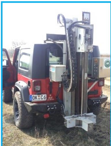
Für größere Flächen empfehlen sie automatische Probestecher an geländegängigen Fahrzeugen.
